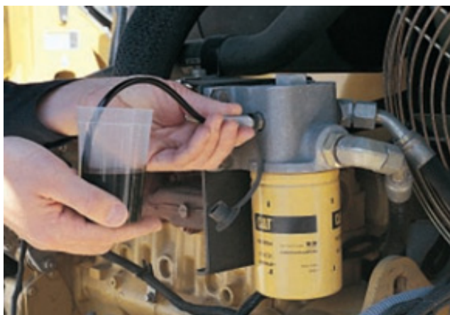
Fig. 2. Paso 2, toma de aceite con válvulas de muestreo [7]
