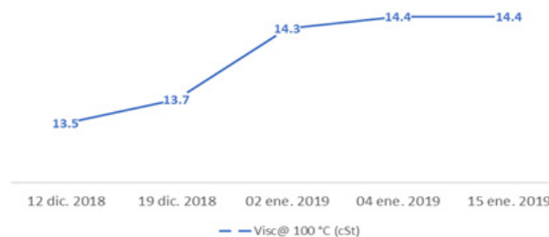
Fig. 8. Gráfica viscosidad vs tiempo del vehículo A [12]
