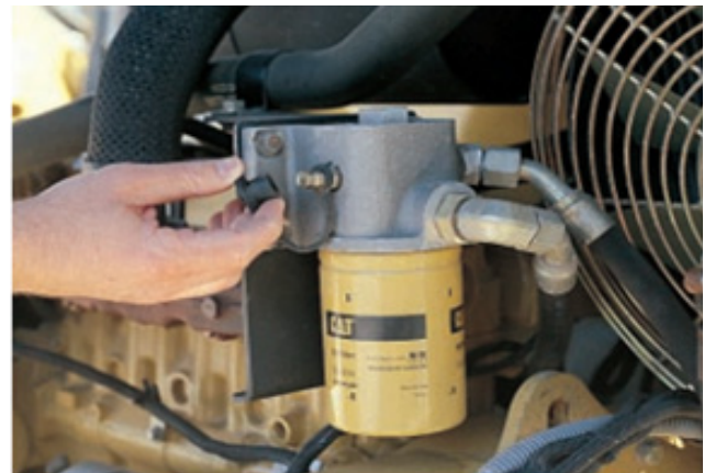
Fig. 1. Paso 1 toma de aceite con válvulas de muestreo [7]
