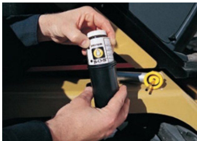
Fig. 4. Paso 4, toma de aceite con válvulas de muestreo [7]
