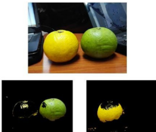
Fig. 5. Máscara de color resultante en el espacio CIElab
