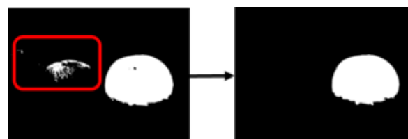
Fig. 6. Filtrado de la imagen binaria.
