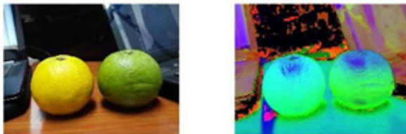
Fig 2. Conversión de la imagen desde RGB a HSV
