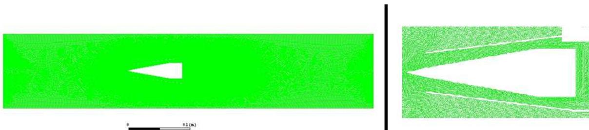
FIG. 7 Enmallado del volumen de control
