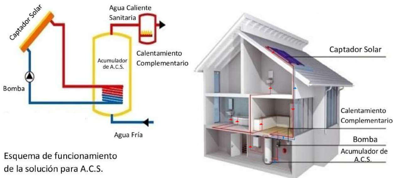
FIG. 1 Esquema de funcionamiento del calentamiento de ACS. [12]
