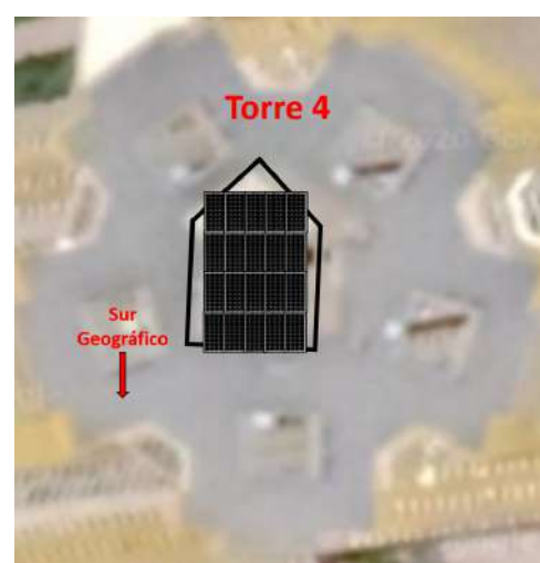
FIG. 6 Orientación de los paneles fotovoltaicos en la torre 4.
